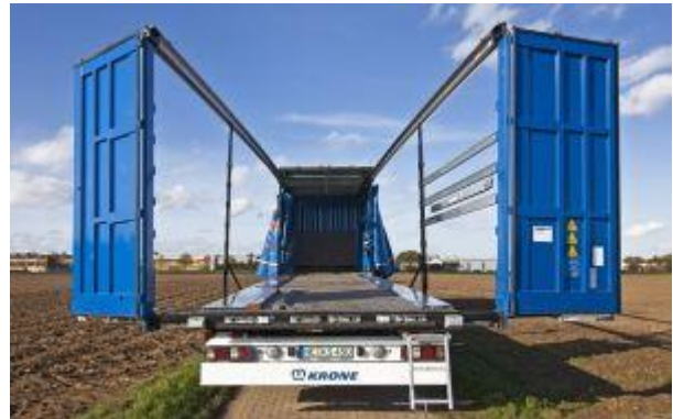
Tautliner, verbreiterbar maximale Breite 3000mm
